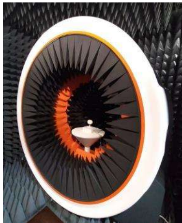
MVG Satimo StarLab 3D 天線測試系統
